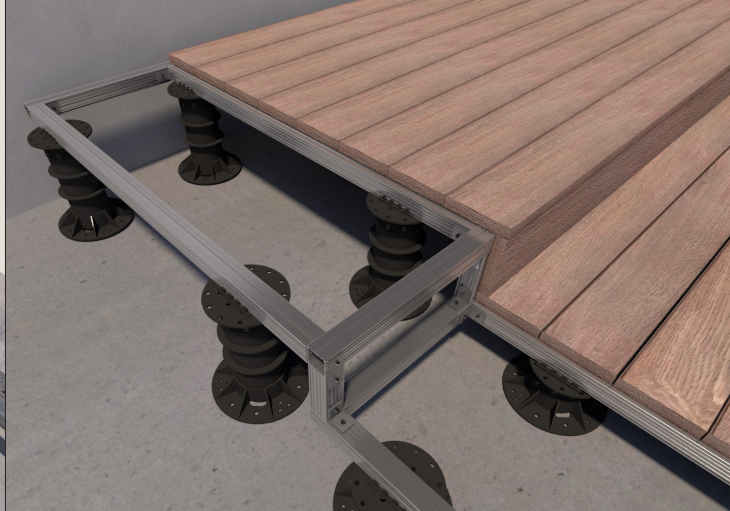
Решение для монтажа многоуровневых фальшполов
