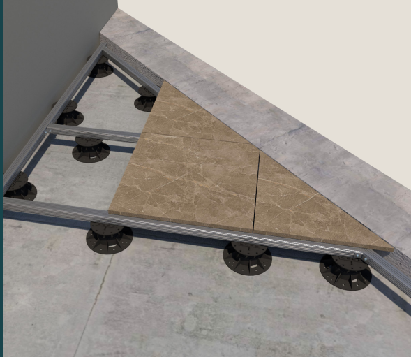
Решение для монтажа криволинейных фальшполов
